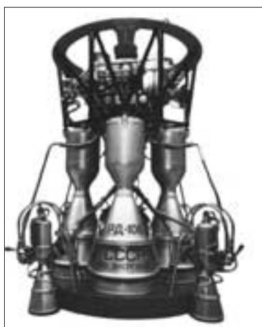
Двигатель второй ступени РД-108
