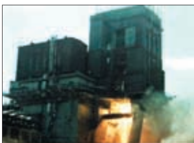
Огневые испытания второй ступени ракеты Н-1
